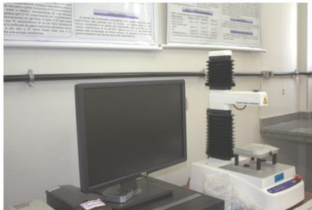
Figura 15 – Equipamento para análise de textura (Texturômetro)
