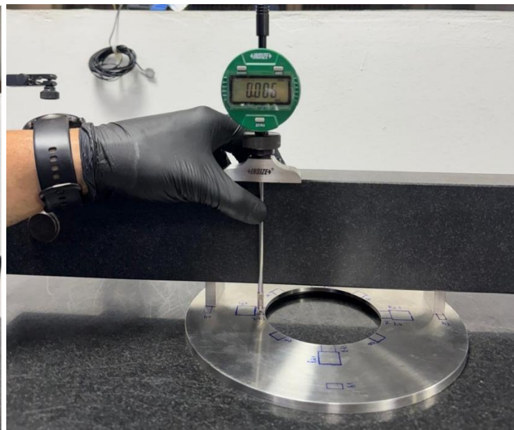
Figura 6 - Calibração de Placa de orifício
