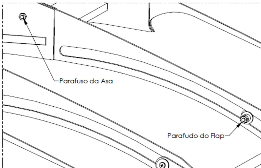
**Figura 49:** Parafusos de fixação do mecanismo.
