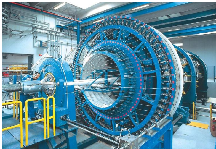
Figura 2 – Máquina de enrolamento de arames de armadura em dutos flexíveis denominada Armadeira.
