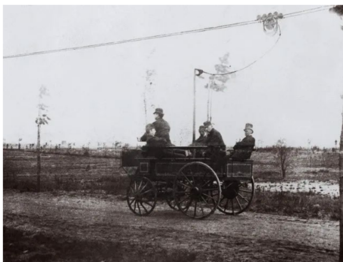
Figura 21: " Elektromote ", o primeiro trólebus construído no mundo. Fonte: SIEMENS, 2025.
