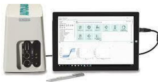
Figura 3-6 – Software e potenciostato usados para captura de dados. Fonte: (METROHM, 2025)
