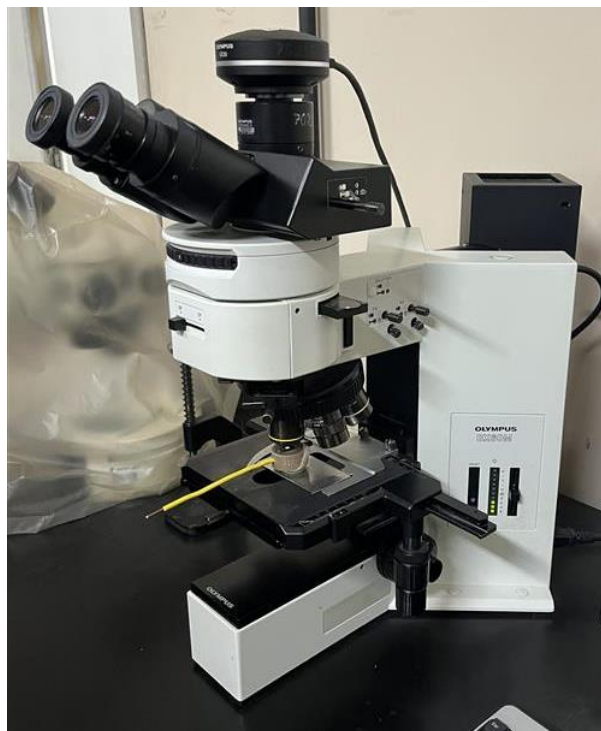
Figura 3-8 - Microscópio óptico Olympus modelo BX60M. Fonte: Autoral; 2025
