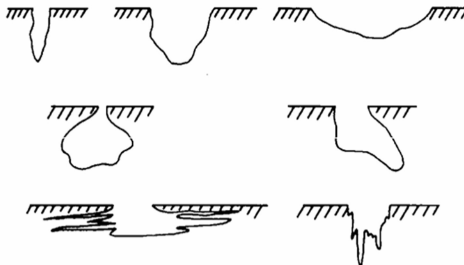
Figura 9 – Variadas formas de pite. Fonte: Adaptação dos autores da (ASTM G46-21, 2021).
