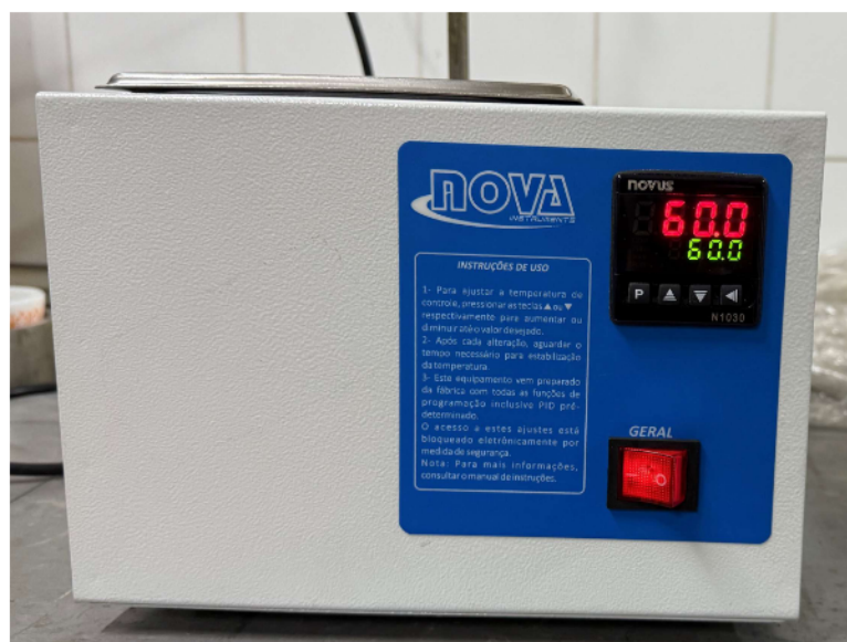
Figura 31 – Banho-maria termostaticado da Nova Instruments ajustado à temperatura proposta Fonte: Elaboração dos autores, 2025.
