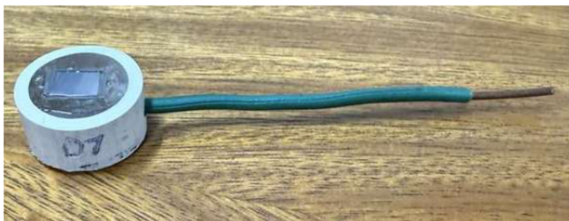
Figura 29 – Eletrodo de trabalho preparados Fonte: Elaboração dos autores, 2025.
