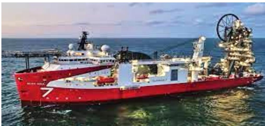
Figura 14: Embarcação *Seven Vega* de lançamento *Reel-Lay*. Fonte: *Subsea 7*
