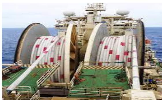
**Figura 7: *Risers* rígidos assentando nos carretéis. Fonte: Technip FMC**
