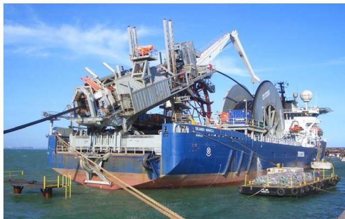
Figura 21: Enrolamento de um *riser* na embarcação *Skandi Navica*. Fonte: *Subsea 7*
