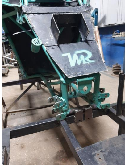
Figura 14: Fixação da parte traseira do chassi na estrutura rígida
