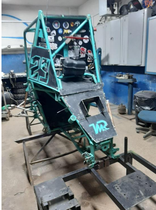
Figura 20: Parte traseira do chassi fixada em estrutura metálica chumbado ao solo da oficina
