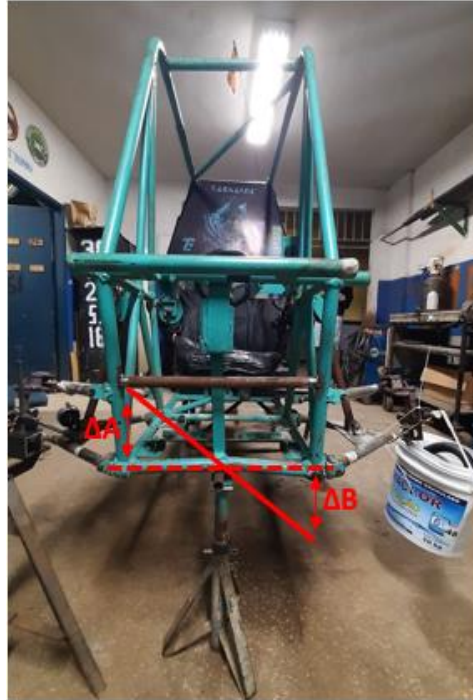
Figura 31: Deslocamento gerados pela carga aplicada no chassi A
