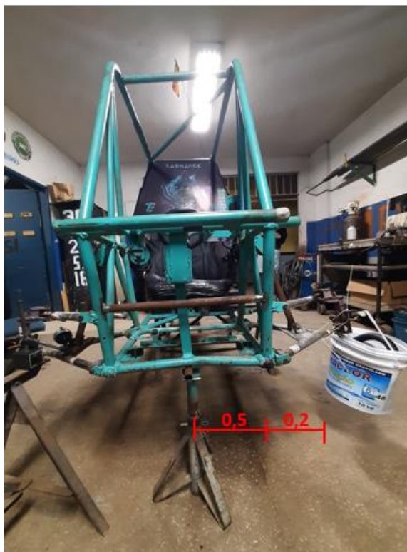
Figura 22: Distância de 0,7 metros entre o apoio central e carga aplicada
