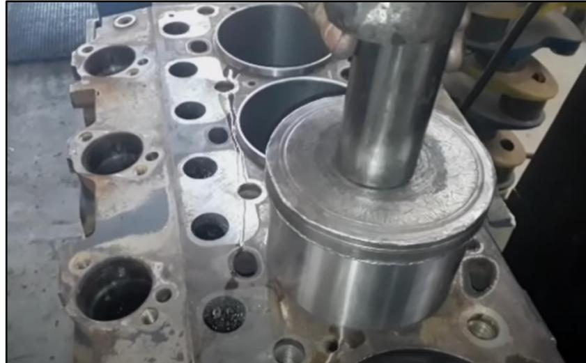
**Figura 2** - Encaixe por ajuste de pressão de uma camisa de cilindro em um bloco de motor
