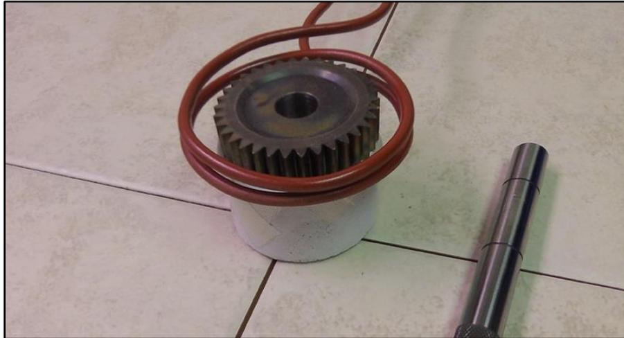
**Figura 3** - Engrenagem sendo aquecida por indução. **Fonte:** *Ambrell Corporation*.
