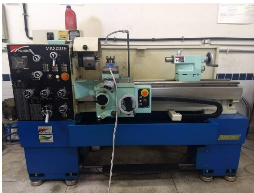
Figura 29 - Torno MS 205 da Indústrias Nardini S/A. (Fonte: Pinheiro.Caio 2021).
