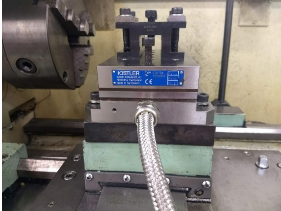
Figura 30 - Dinamômetro Kistler modelo 9257 BA (Fonte: Pinheiro. Caio 2021)
