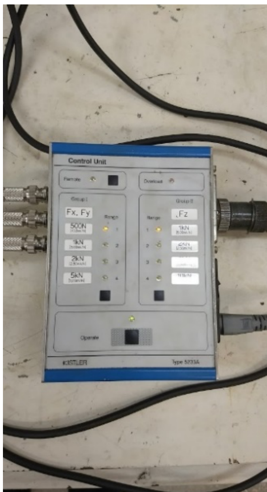
Figura 31 - Condicionador de sinais Kistler modelo 5233 A (Fonte: Pinheiro. Caio 2021)
