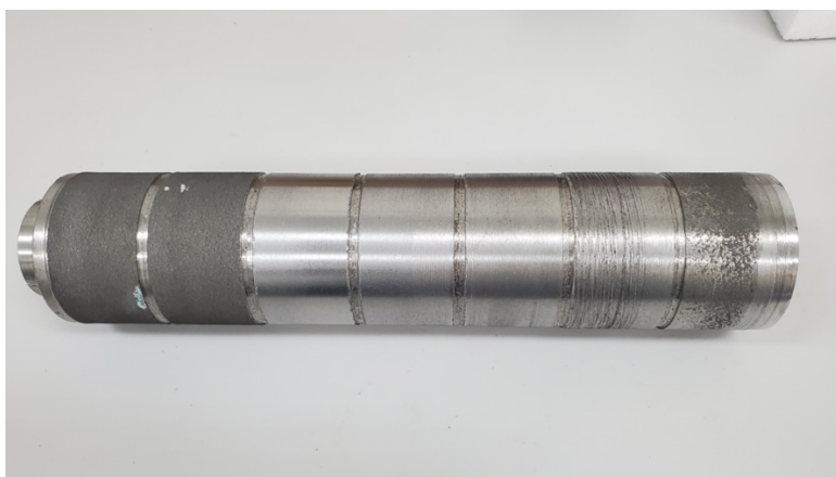
Figura 26 - Fotografia do corpo de prova com substrato de aço AISI 420 C aspergido termicamente (Fonte: Autor)
