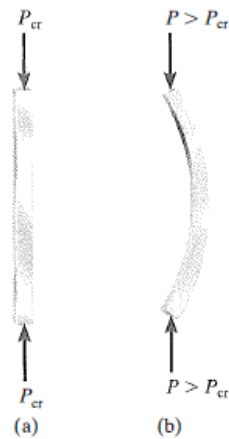
Figura 7 – Iminência de flambagem pela carga crítica (HIBBELER, 2010).
