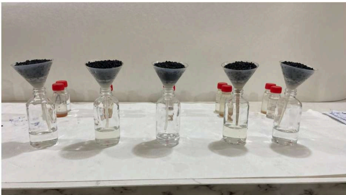
Figura 26 – Montagens para filtração com Carvão Ativado Parceria com um aluno de UMaT (Mcmanuel Owusu Afriyie 2025)
