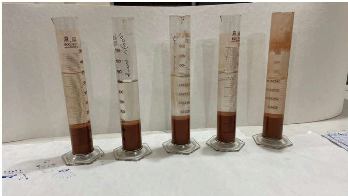
Figura 24 – Configurações de Sedimentação com Diferentes Concentrações de Coagulante de Moringa, Cal e Sem Coagulante.
