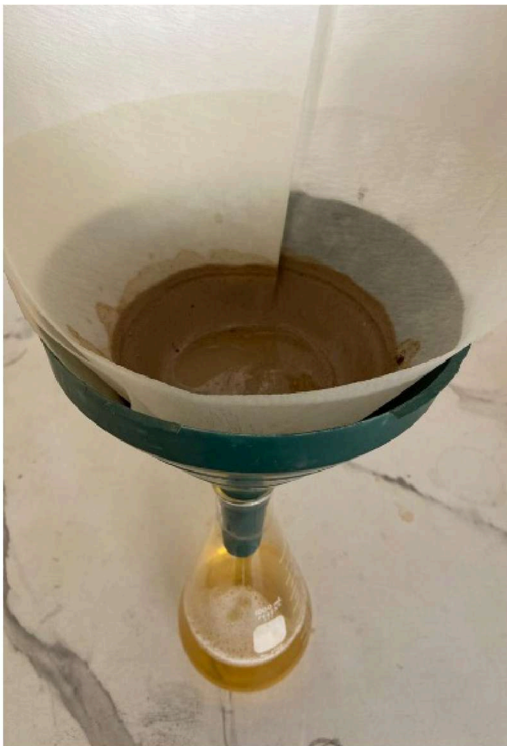
Figura 23 – Filtração do coagulante e amostra da água do rio Parceria com um aluno de UMaT (Mcmanuel Owusu Afriyie 2025)
