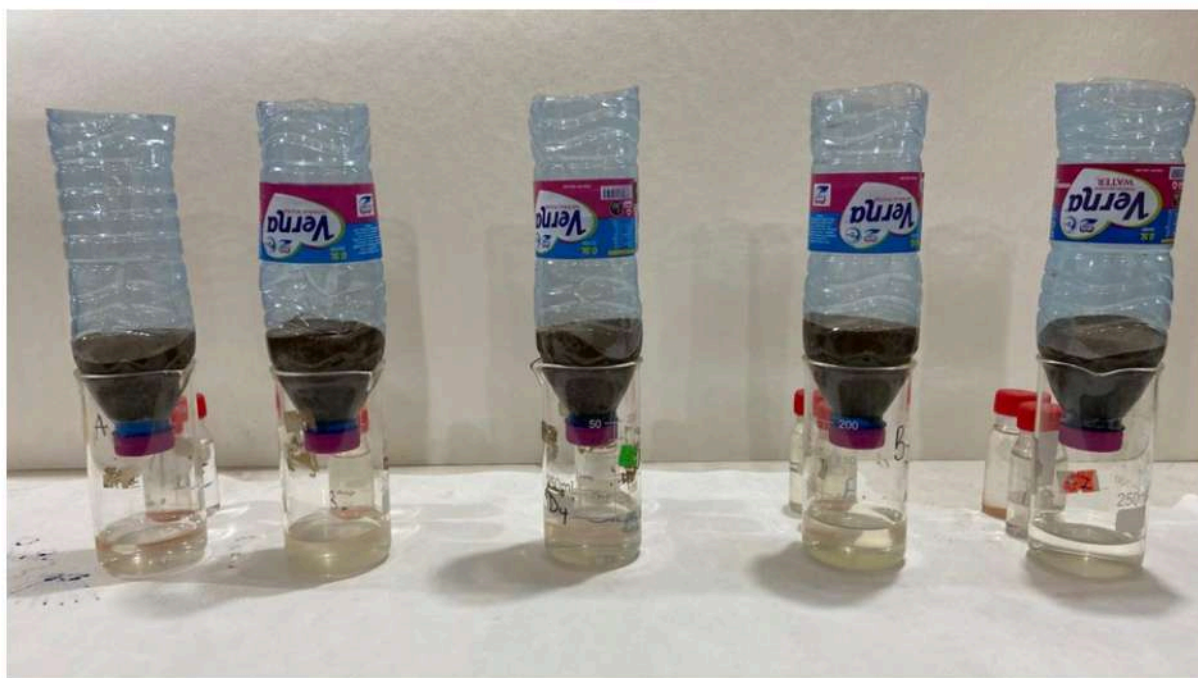
Figura 25 – Montagens para Filtração com Areia
