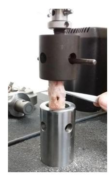
Figura 16 - LCP sendo posicionado nas garras da INSTRON
