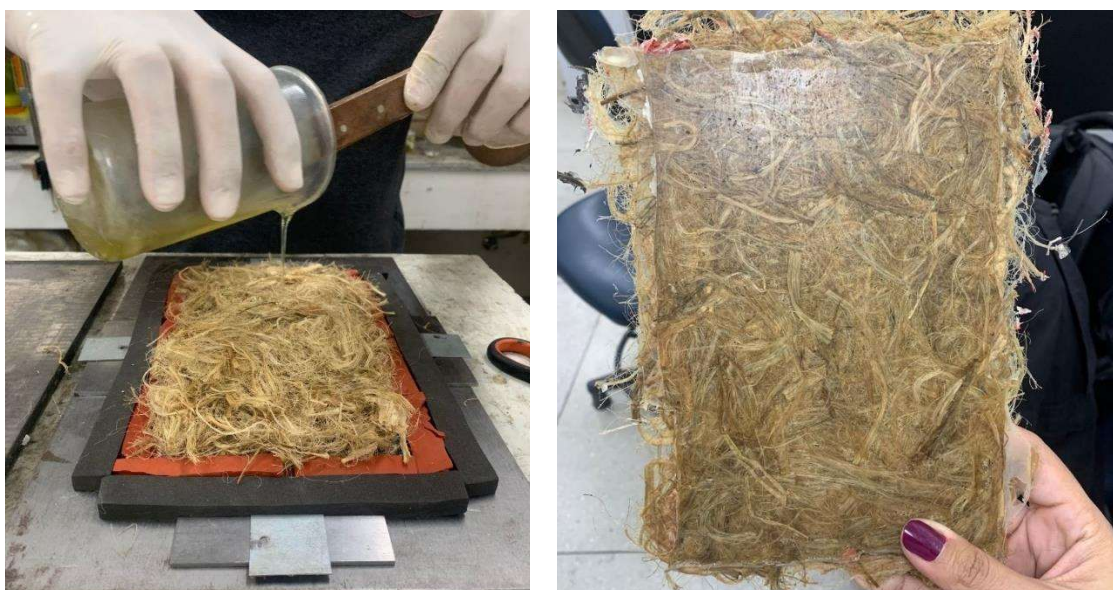
Figura 32 A58-Fabricação da placa com uso de molde. B- Placa após cura e retirada do molde. 596061Fonte: De 62autoria própria. 636465Fonte: De 66autoria própria.
