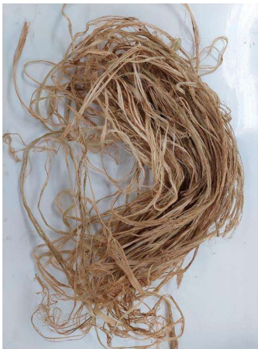
Figura 2327-Fibra de curauá in natura. Fonte: De 28autoria própria.
