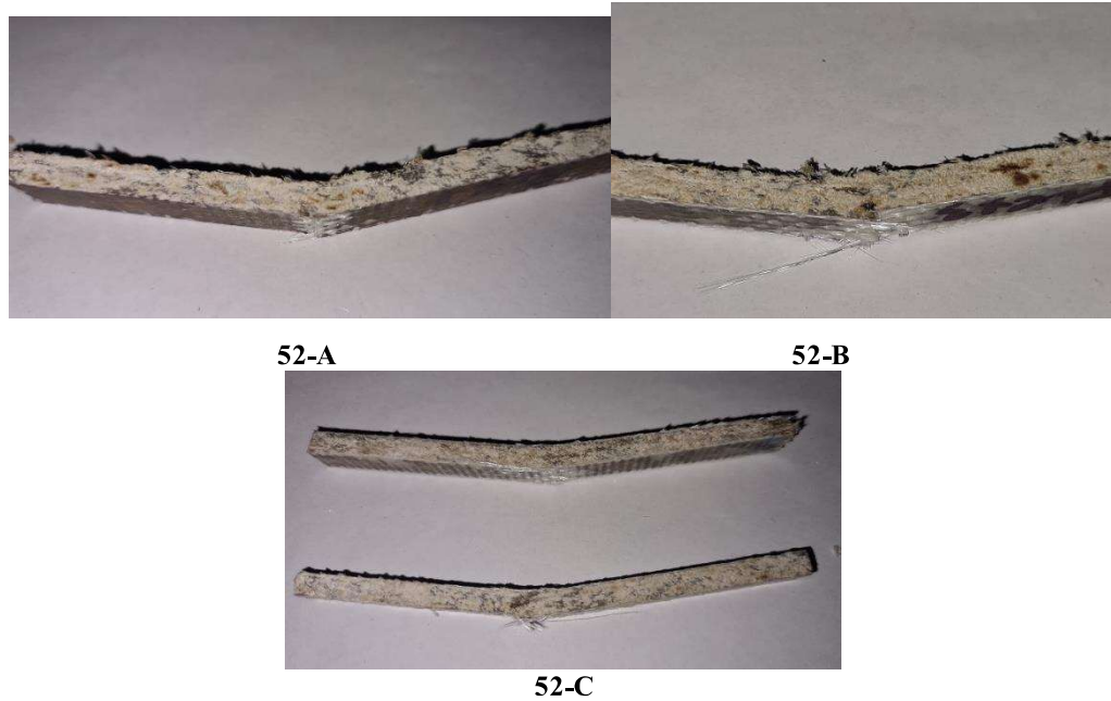
Figura 52-A 102-Corpo de prova após ensaio de flexão (GC). B 103-Detalhe de corpo de prova após ensaio de flexão (GGC).C 104-Corpos de prova deformados após ensaio de flexão (GGCGG).
