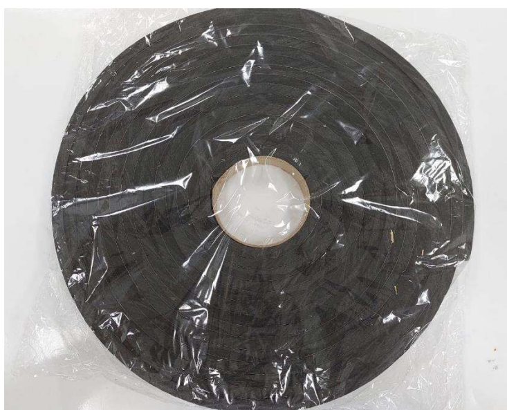
Figura 3048-Espuma adesiva usada no molde. 495051 Fonte: De 52 autoria própria.
