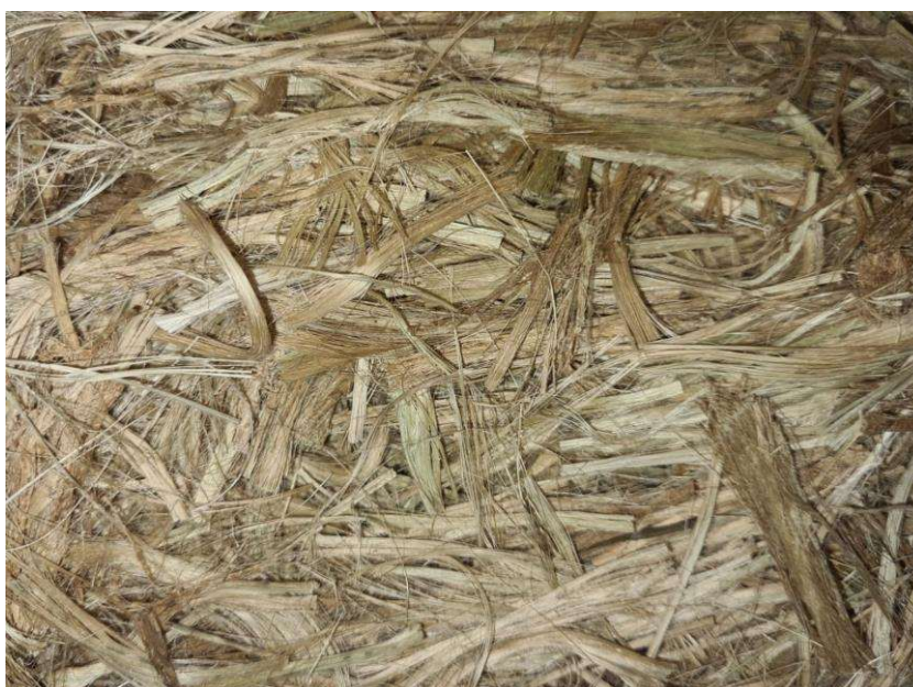
Figura 2739-Fibra curta de curauá. 40 Fonte: De 41autoria própria.
