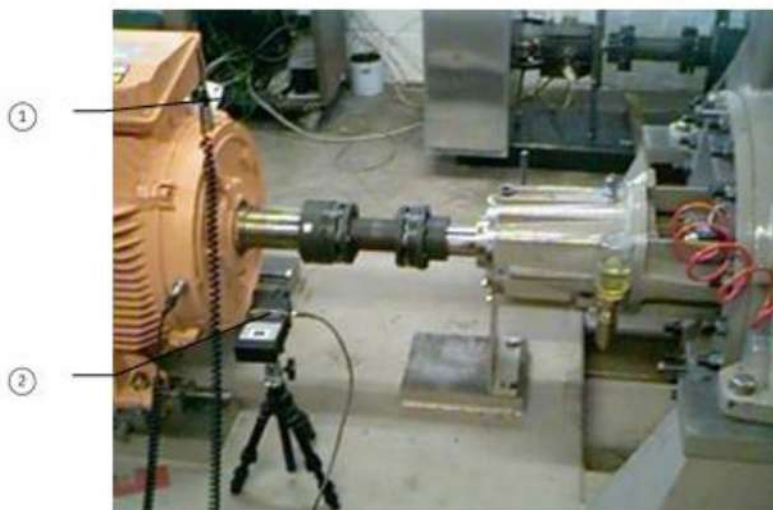
Figura 24 - Conexão dos cabos com os sensores Fonte: SKF (2015)
