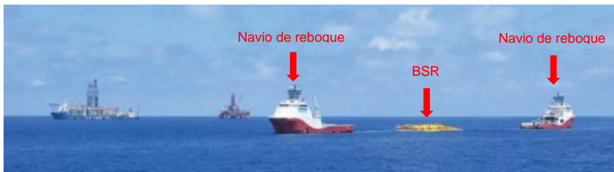
Figura 15 - Operação de reboque de uma BSR
