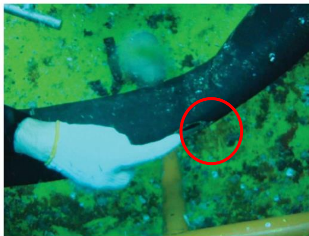
Figura 16 - Furos encontrados nas mangueiras temporárias
