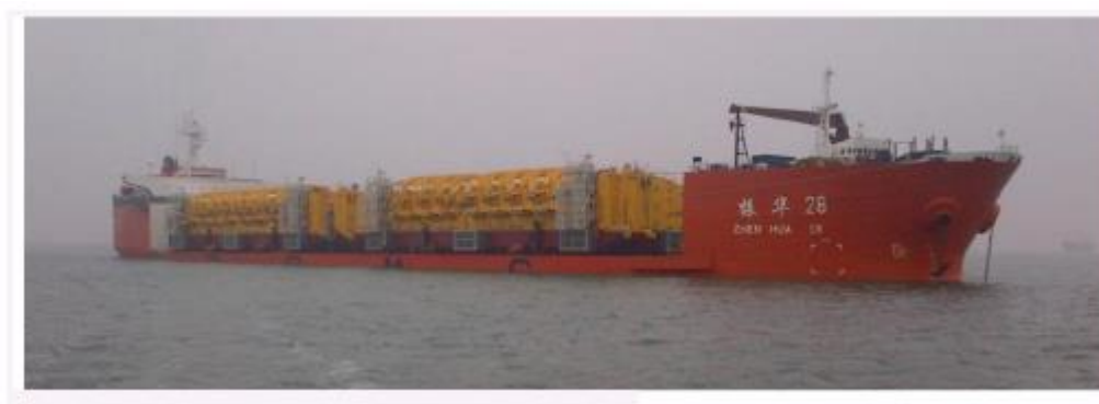
Figura 11 - Navio semissubmersível transportando duas BSR
