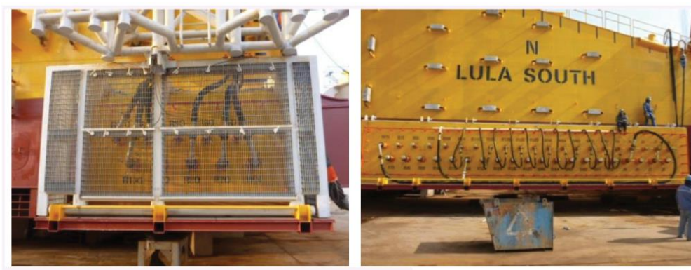
Figura 13 - Painéis de acesso aos tubos de ar e água dos sistemas de lastro das BSRs
