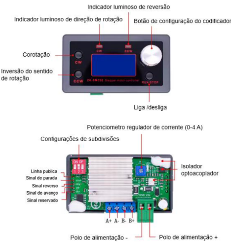
Figura 12- Controlador e Driver do motor HT23-401 Fonte: Adaptado Aliexpress (2024)
