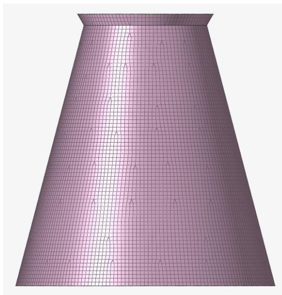
Figura 13 – Vista lateral de um modelo para exemplificação da malha criada com elementos de 3 milímetros
