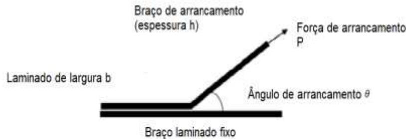
Figura 5 - Esquema Fixed Arm Peel Test (Moore et al. 2010, adaptado)
