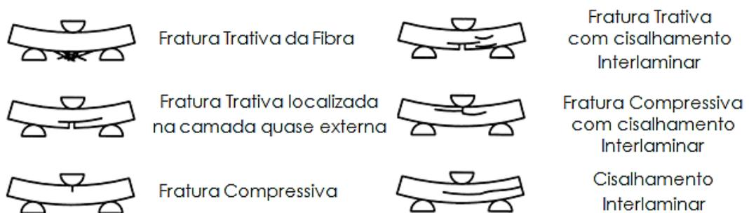
**Figura 34:** Modos de falha em ensaios de flexão de 3 pontos (ISO 14125, 2011)
