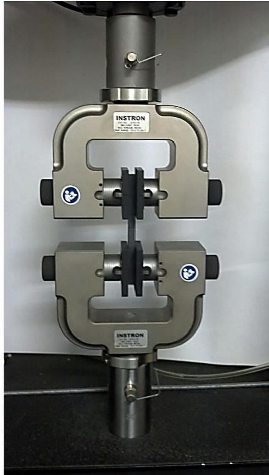
**Figura 24:** Posicionamento do corpo de prova montado para ensaio de tração.
