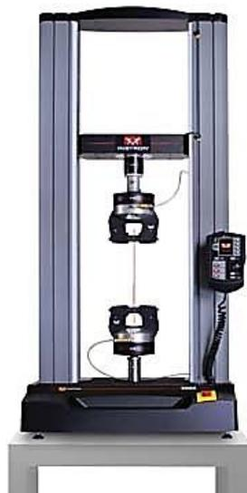
**Figura 22:** Máquina de ensaios universal Instron modelo 5966.
