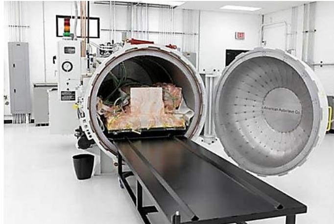
**Figura 10:** Autoclave utilizado na Formula 1(FORMULA 1,2014).
