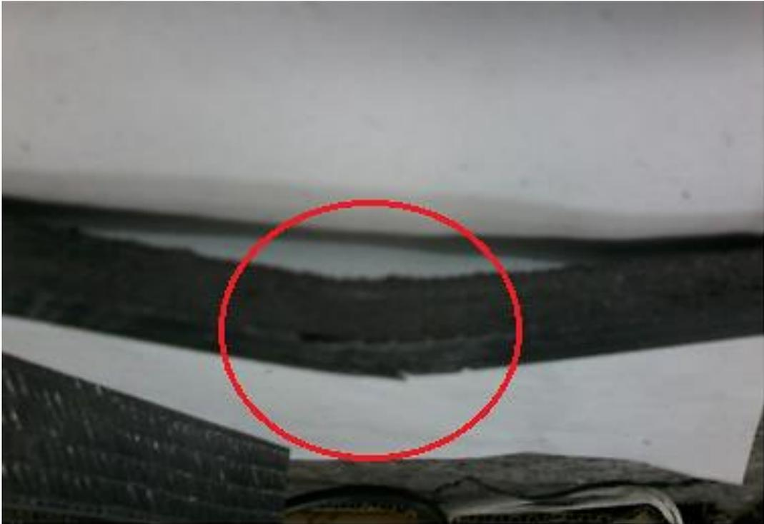
**Figura 33:** Região de falhas no compósito orientado a  $0^{\circ}/90^{\circ}$
