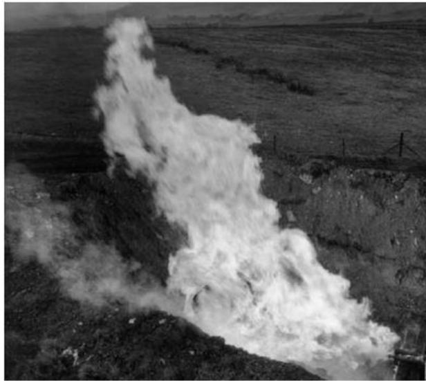
Figura 6- Incêndio em jato horizontal de propano sob tanque de 2 toneladas (4)
