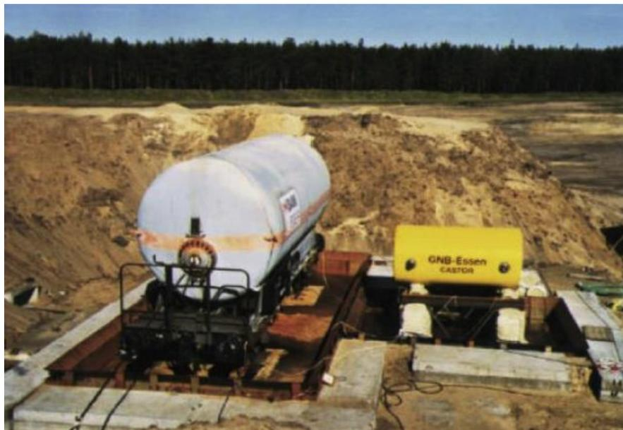
Figura 9- Ensaio experimental com um vagão tanque com propano sob trilhos, realizado pelo BAM- Alemanha (5)
