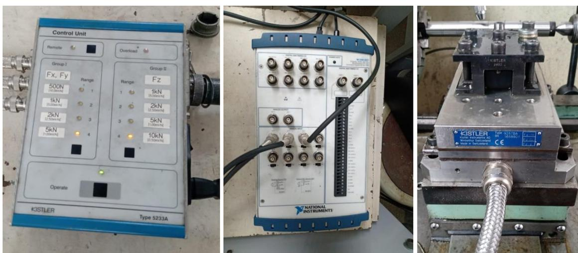
Figura 23 – Sistema de aquisição de dados: dinamômetro e conexões
