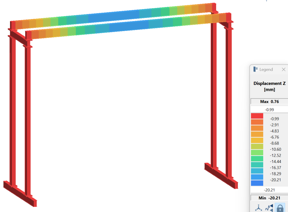
Figura 61 – Resultado da deflexão na viga principal Fonte: Autoria própria (2025)
