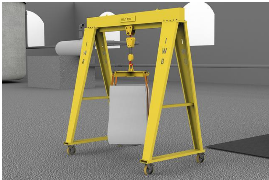
Figura 3 – Pórtico rolante monoviga Fonte: Grupo IW8 (2024)
