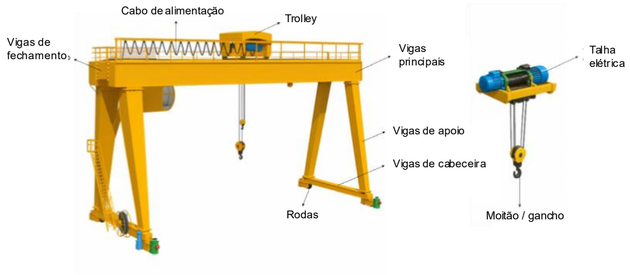
Figura 5 – Componentes de um pórtico rolante
