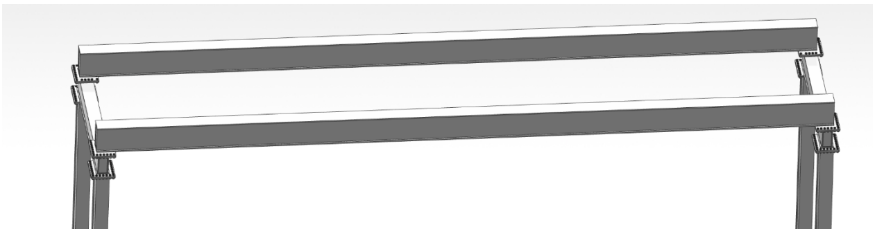
Figura 19 – Vigas principais Fonte: Autoria própria (2025)
