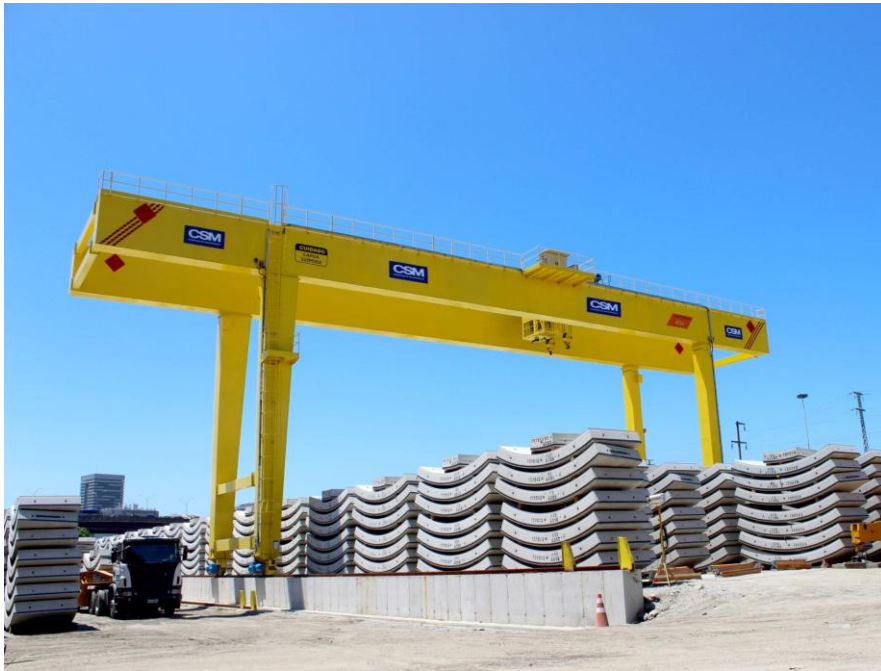
Figura 4 – Pórtico rolante dupla viga
