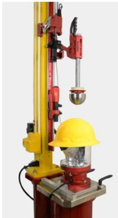
**Figura 52 – Penetrador Linear instalado na máquina monotrilha Cadex**
