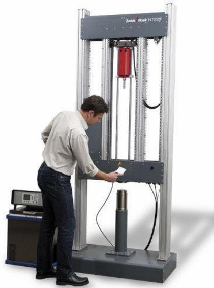
**Figura 10 - Máquina de ensaio por queda de peso**
