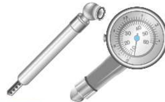
Figura 1.21 Manômetro para calibração da pressão de pneus automotivos.
